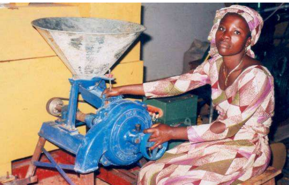
La plateforme multiservices mise en place par GERES pour KPODEHOU dans le cadre du programme SETUP. L'équipement en bleu est un moulin destiné à la transformation du maïs et du soja.
