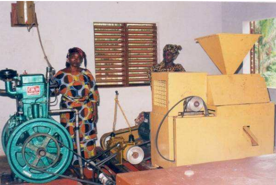
La plateforme multiservices mise en place par le GERES pour KPODEHOU dans le cadre du programme SETUP. L'équipement jaune est une presse de fruit de palme qui remplace le travail manuel (voir photo en haut). La présidente est à côté du moteur vert.
